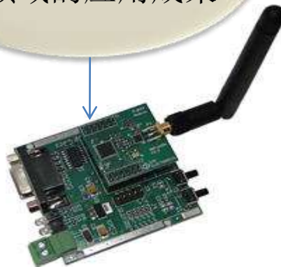
2012年为某公司开发的 Zigbee无线通讯模块
