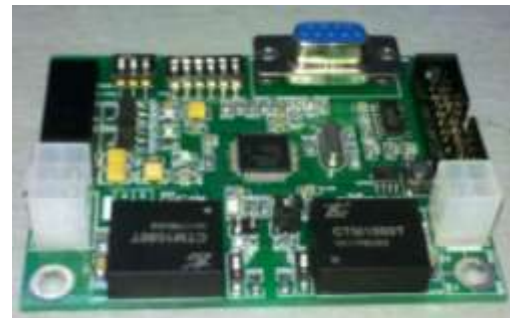
2012年为某焊接企业开发 DeviceNet转CAN通讯模 块
